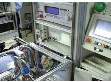
インバータの性能検査装置やDC-DCコンバータ耐久試験機に実績があります。パワー素子を駆動して行う熱抵抗検査や、漏れ電流検査の試験機も手がけています。
