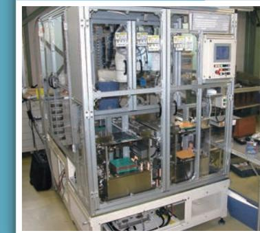
加速度センサ、ライトセンサ、傾斜センサなど車載センサの試験機に実績があります。加速度センサの衝撃試験では、シャルピー衝撃試験を応用した、ハンマリングによる自動検査装置を開発しています。
