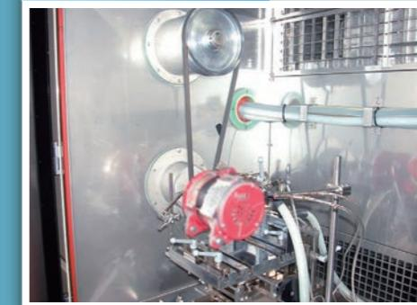
性能検査、環境シミュレーション、画像処理による外観検査、防音室を用いた異音検査などに実績があります。レギュレータやレクチファイヤなど、機能部品の検査装置も開発しています。
